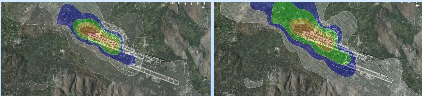
Νέο Αεροδρόμιο Καστελίου : Ισορροπαντικές καμπύλες (α) NO x σε µg/m 3 και (β) ΑΣ 2.5 σε µg/m 3 για το χρονικό σενάριο του 2025
